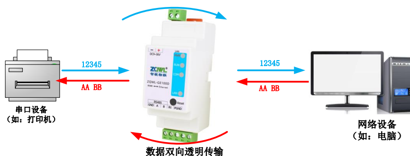
图 3.21 设备透传应用框图
