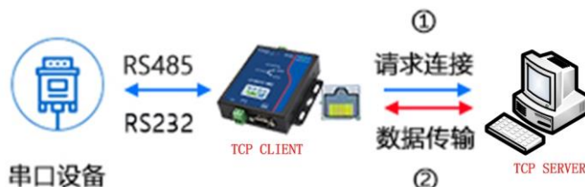
图 3.5 TCP CLIENT 模式工作原理
