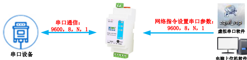
图 4.6 自设波特率原理框图
