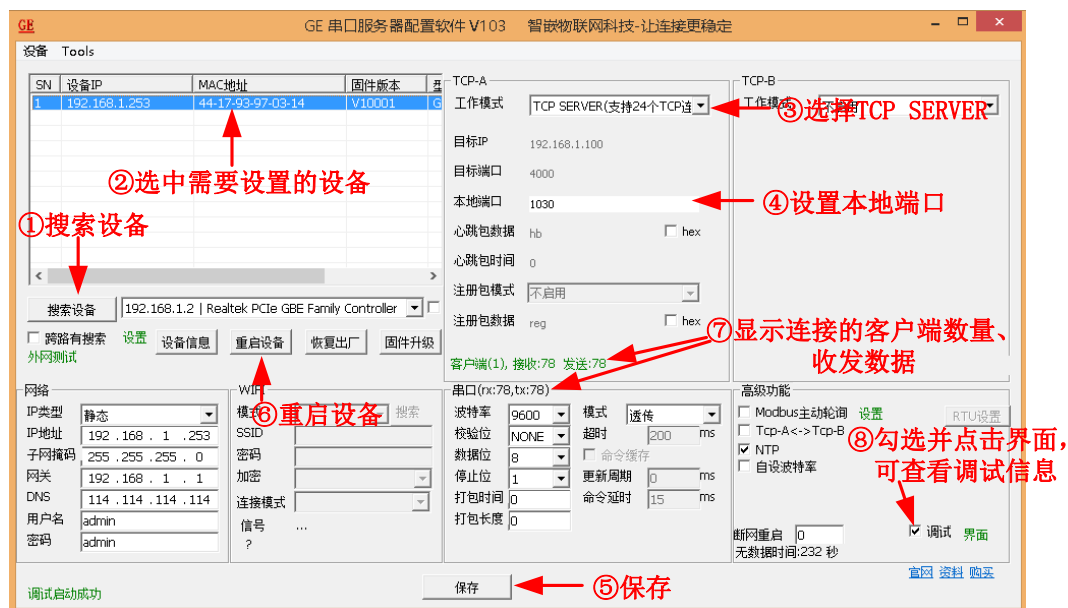
图 3.3 TCP SERVER 模式配置方法
