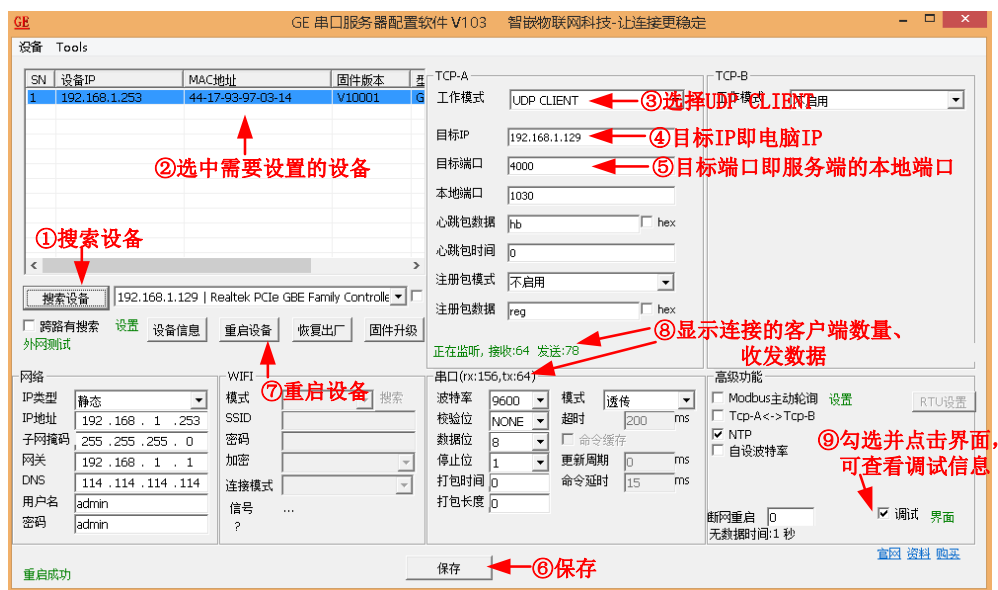
图 3.11 UDP CLIENT 模式配置方法
