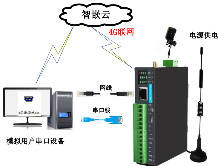
图 4.16 远程采集串口设备数据示意图
