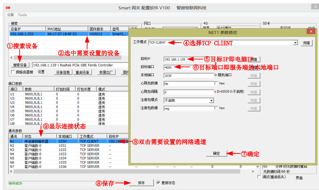
图 3.6 N1 通道配置为 TCP CLIENT 模式
