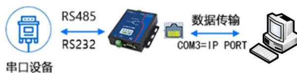
图 3.20 虚拟串口工作原理
