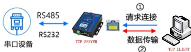
图 3.2 TCP SERVER 模式工作原理
