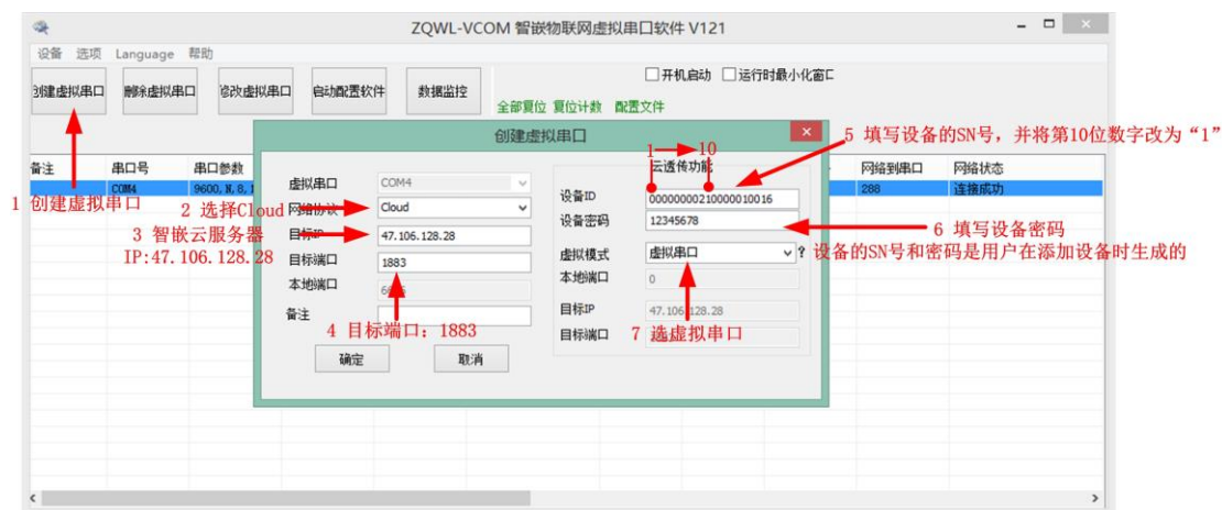
图 4.30 虚拟串口接入智嵌云并绑定设备步骤
