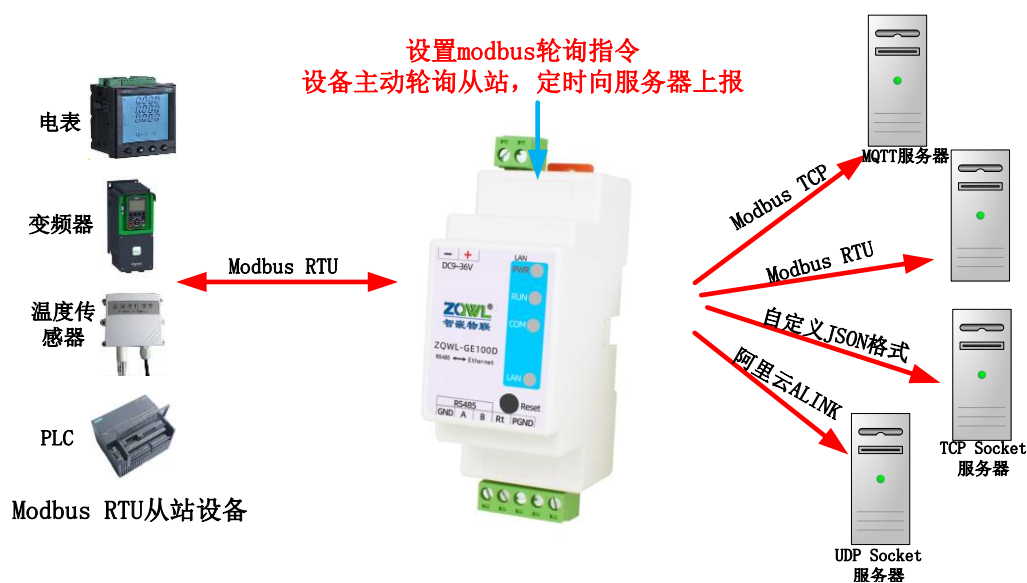
图 5.1 Modbus 主动轮询原理框图
