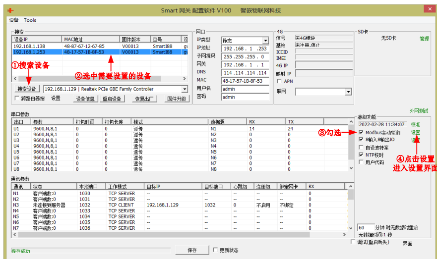
图 7.5 主动轮询配置
