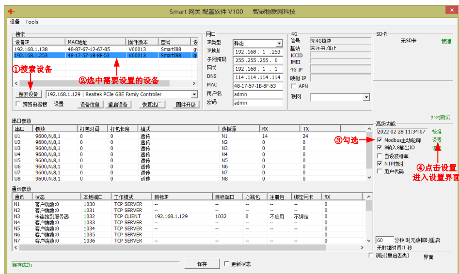
图 7.2 Modbus 主动轮询功能配置步骤 1
