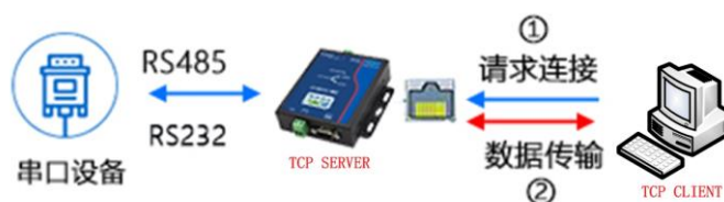
图 3.2 TCP SERVER 模式工作原理
