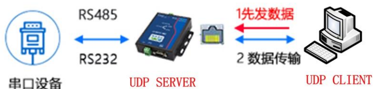
图 3.8 UDP SERVER 模式工作原理
