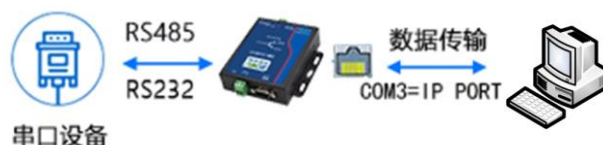
图 3.20 虚拟串口工作原理
