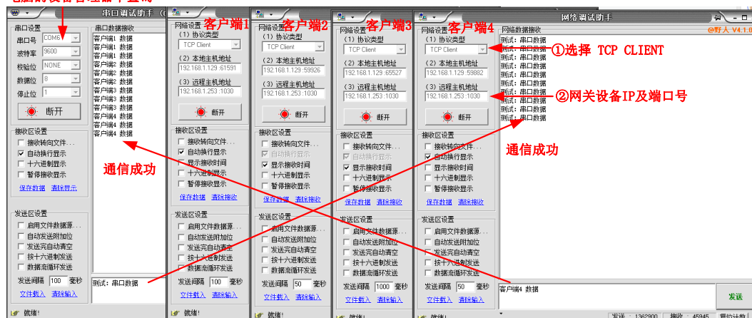
图 3.4 TCP SERVER 模式下连接多个客户端
