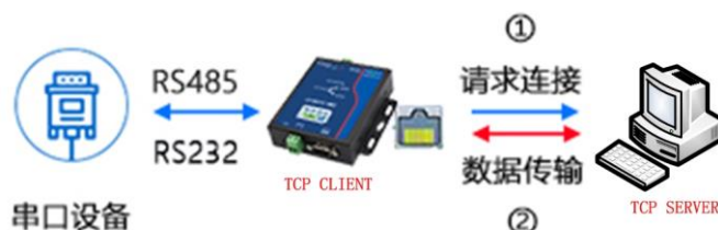
图 3.5 TCP CLIENT 模式工作原理
