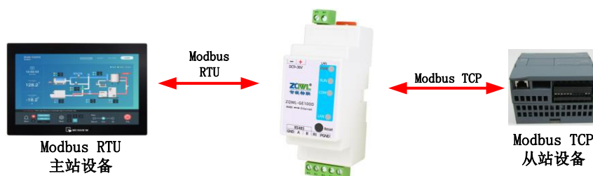
图 3.26 ModBus TCP/RTU 互转（主）模式应用框图
