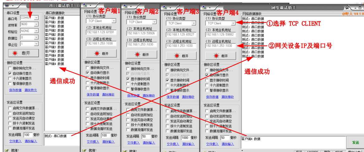
图 3.4 TCP SERVER 模式下连接多个客户端
